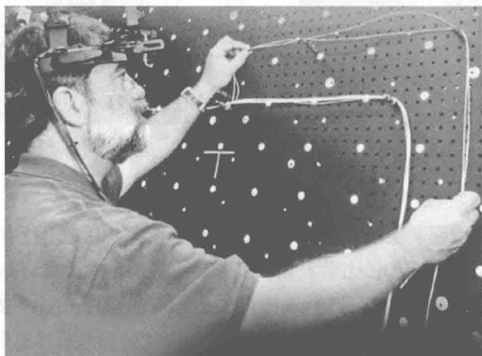
图 1.6 波音公司增强现实布线系统
