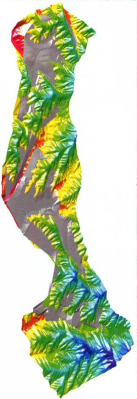
图3.3-29 在Civil 3D中将设计曲面和原始曲面叠合分析展示
