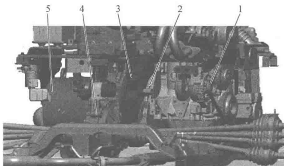
图 1-3 增程式电动汽车动力总成前舱布置方案
