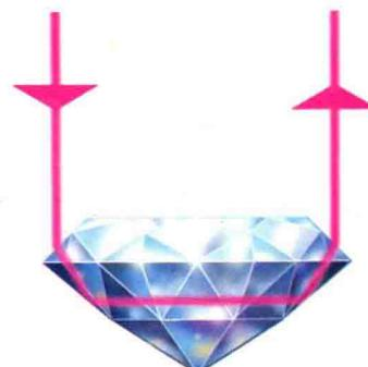
使用低功率激光照射金刚石，通过激光的反射和折射可以判断金刚石的各个面是否已磨成等角。
