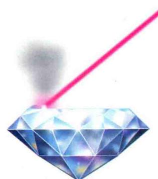
功率中等的激光可以削去金刚石粗糙的边角，使它的表面变得更加平整。
