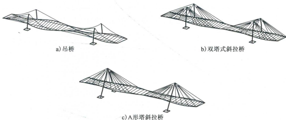
图 1.5 悬索桥和斜拉桥的振动模式
