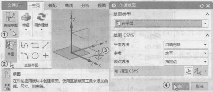
图 1-5 选择绘制草图平面
