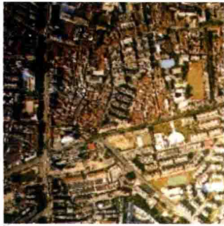
(b) 框幅式影像辐射不均匀
