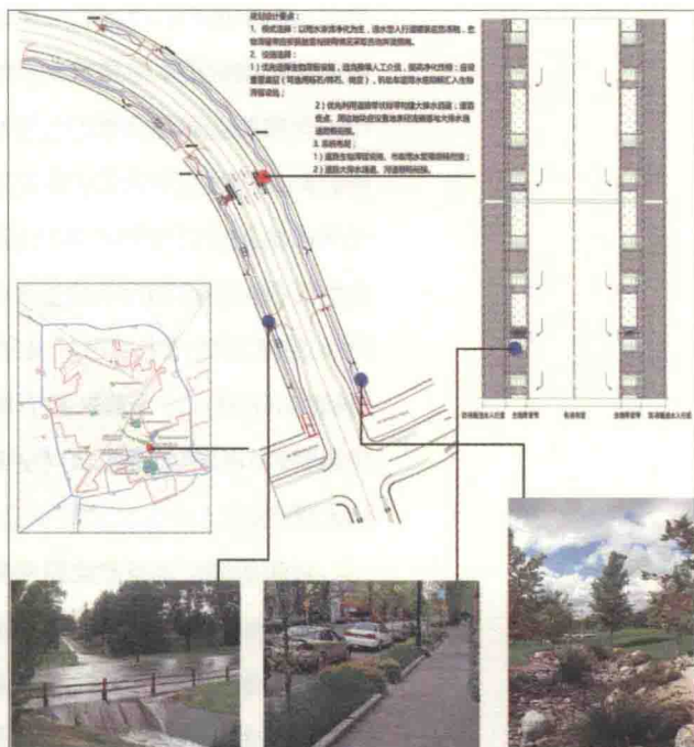
图1-4 白城市海绵型道路与道路行泄通道规划设计指引图（白城海绵办供图）
