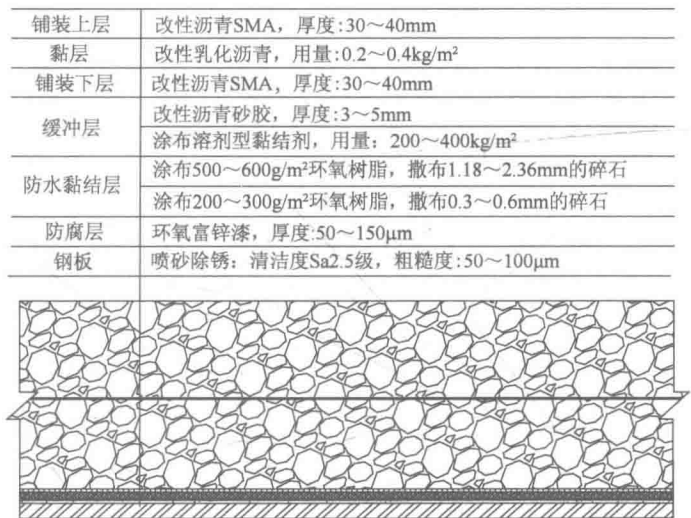
图 3 改性沥青 SMA 铺装体系典型结构
