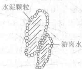
图 1-3 水泥浆的絮凝结构
