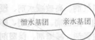
图 1-1 表面活性剂分子结构模型
