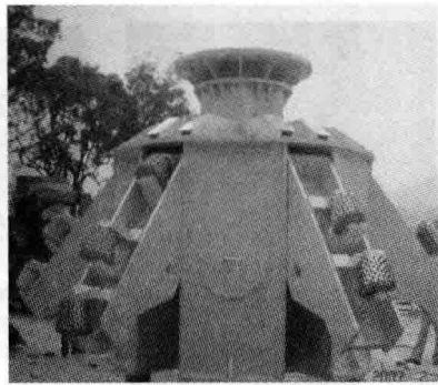
钻孔桩机械扩底钻头
