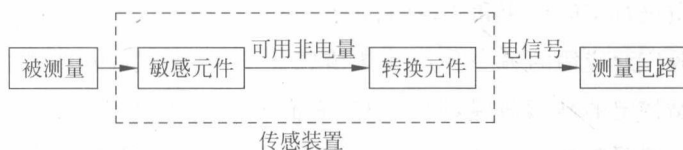
图 1.1 传感器工作模式示意图
