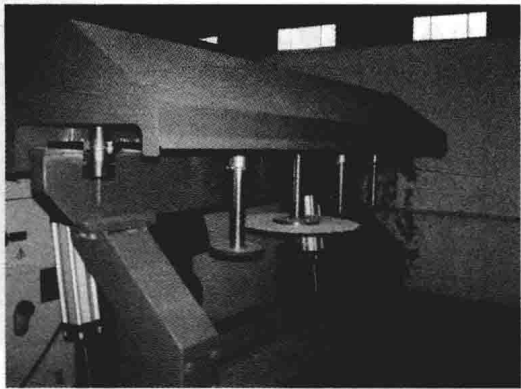
图 1-16 雕刻工业机器人的刀库
