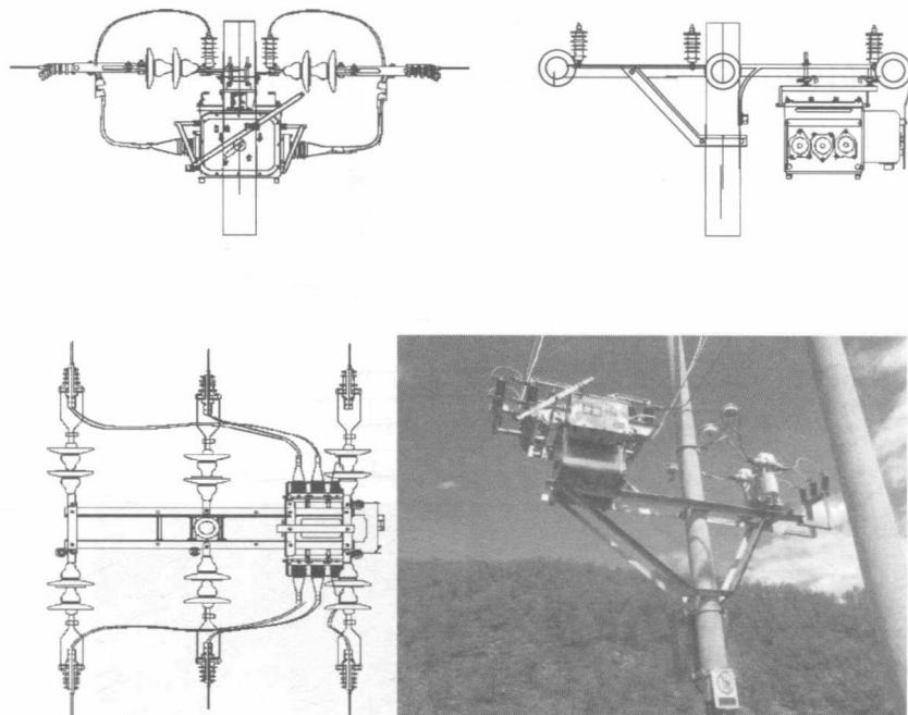
工艺说明：杆上断路器和负荷开关的安装要点：
