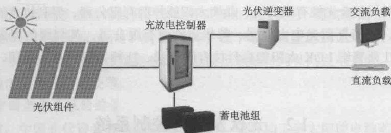
图 1-2-2 太阳能光伏系统工作原理
