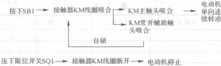
图 1-4 自动卷帘门继电-接触器工作过程
