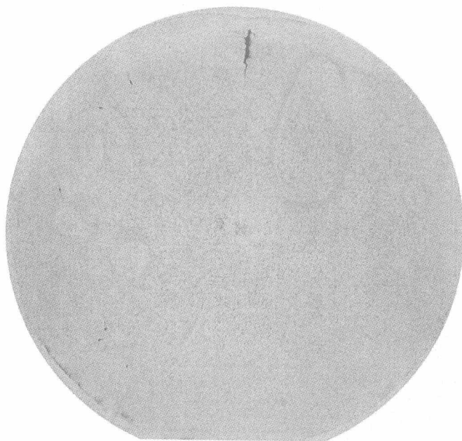
图 2-6 硫印检验的圆坯皮下裂纹
