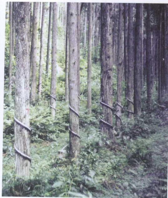
▲► “杉木人工林生态系统结构与功能规律的研究”，揭示了杉木群体结构、生物产量、养分循环与能量转换规律。图为地表径流测定系统（左）和集束式树干径流测定系统（右）
