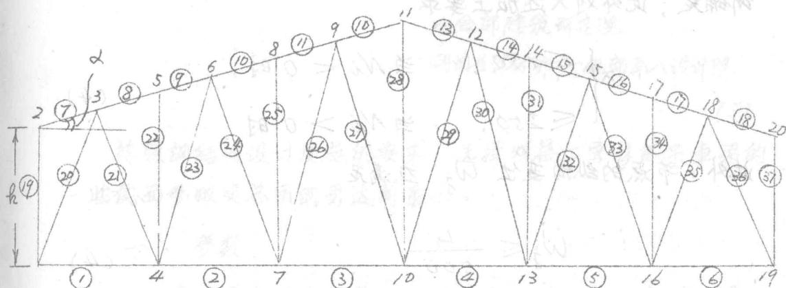
假定此桁架承受两种载荷的作用，一种为对称的载荷（如屋顶尖重），一种为单边载荷（例如在施工过程中所受的力），则它应满足平衡条件、连续性条件、强度要求等。
