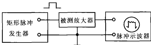
图 1-2 暂态法测试宽带放大器的接线图
