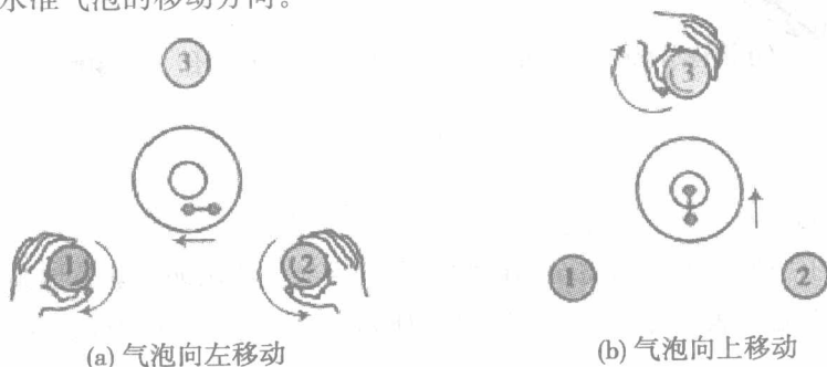
图 2-1-3 用脚螺旋粗平
