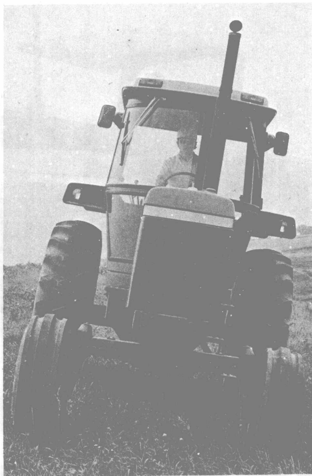
圖 6 曳引機之寬前端。此種裝設可增加曳引機之安定性。
