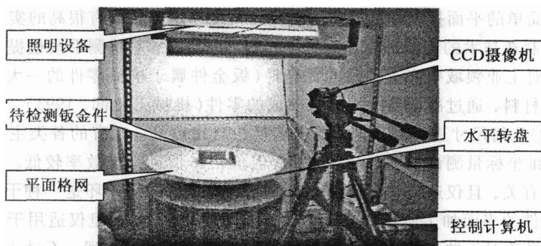
图 1.3.1 视觉检测系统的硬件构成
