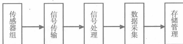
图 1.1 数据采集型测试系统结构
