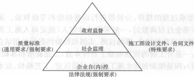
图 1-1 建筑工程施工质量保障体系图
