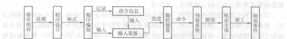
图 1-2 数控机床的工作过程
