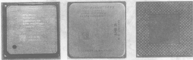
图 1-3 INTEL P4 3.0E -775 AMD Athlon64 FX AMD Athlon XP CPU 针脚图
