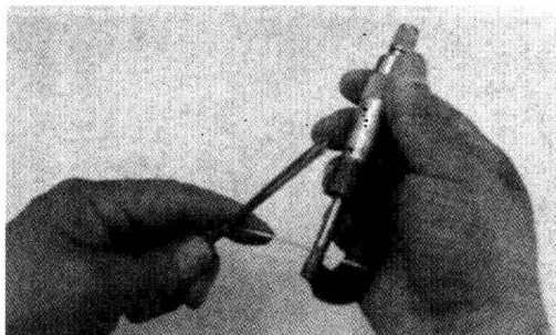
图 1-10 千分尺测量线芯直径
