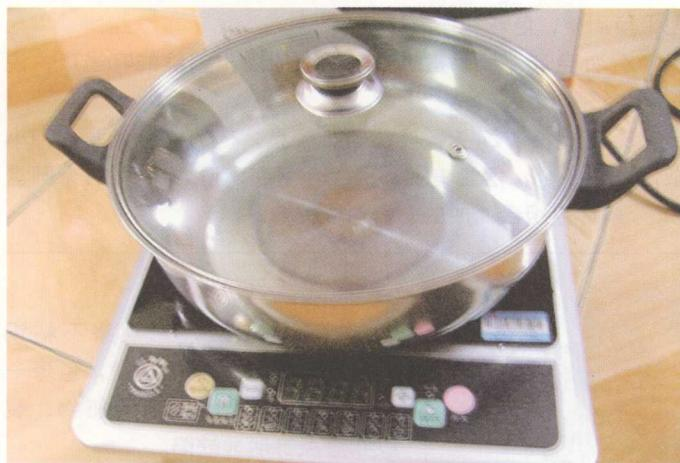
检查炉面外观。外观应平整和无损伤，如炉面有凸凹或某一侧倾斜，会影响热效率的正常产生；电磁炉炉面、侧面、底部等处，不可有碰伤或擦伤。
