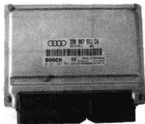
图 1-3 发动机 PCM 的外形
