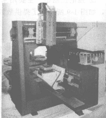
图 1-11 带工件换台及换刀装置的机床本体
