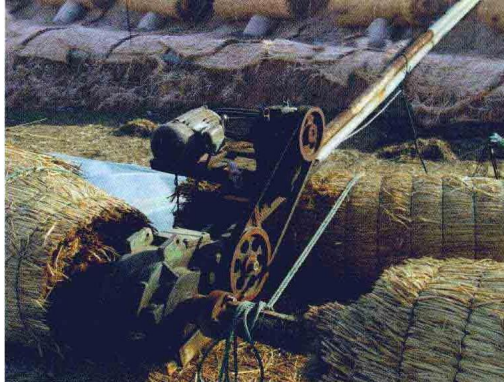
彩图2.2 带有两个减速器的自制折臂式温室卷帘机
