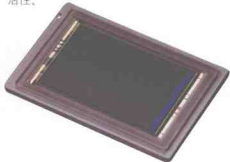
▲这一片CMOS会有1200万像素，解像度超越135胶卷。
