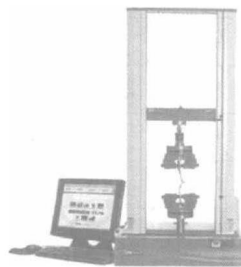
图 1.2 Instron 3367 电子试验机
