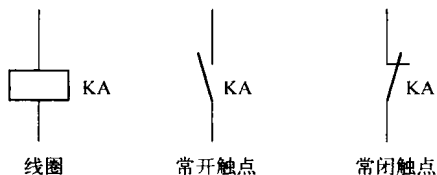
图 1-8 中间继电器图形和文字符号
