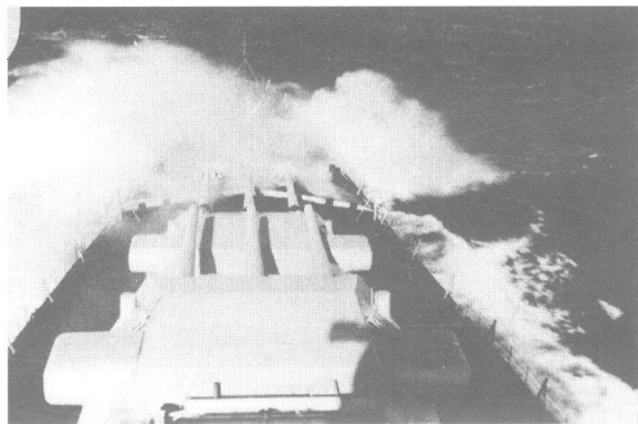
图为在“沙恩霍斯特”号舰桥部分拍摄的舰首照片。我们可以看到舰首部分涌进了很多海水。海水频繁地涌入前甲板使舰首部分炮塔的电子装置经常出问题。
