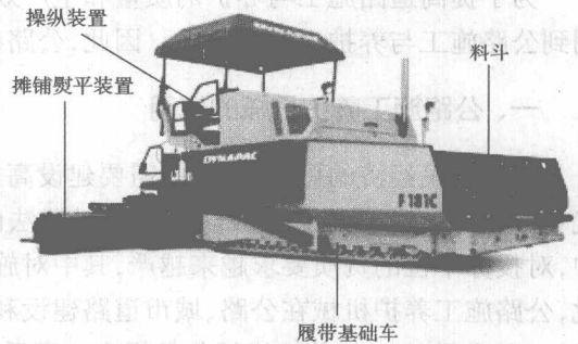
图 1-2 沥青摊铺机总体结构
