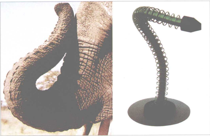
图 1-18 根据大象鼻子的活动原理设计的机械臂
