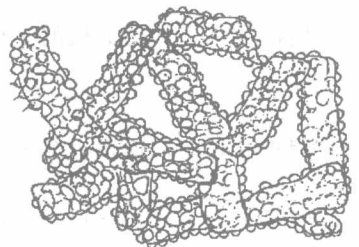
图 2-5 正极活性物质的微观结构模型
