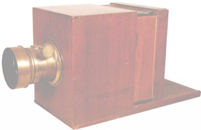
达盖尔法的推拉抽屉式木制座机，法国1850年制造。铜制镜头，装备了齿轨机械调焦装置，使用平版感光材料。
