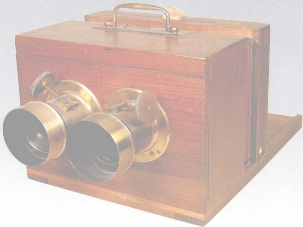
达盖尔法的推拉抽屉式木制座机，法国1852年制造。拍摄规格120mm x 240mm。这是立体摄影的开创型相机。两个铜制的镜头，装有金属齿轨机械调焦装置。
