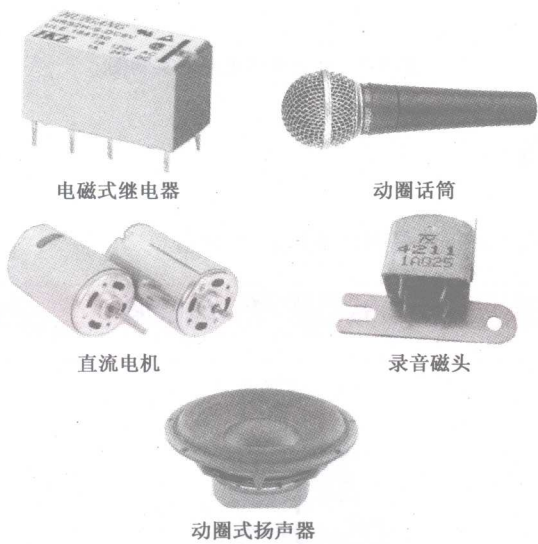
图 1-2 部分电感类元器件实物图
