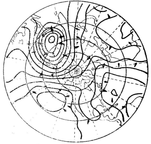
图11 由GFDL模式模拟得到的夏季200hPa速度位势差 \Delta\chi 的分布
