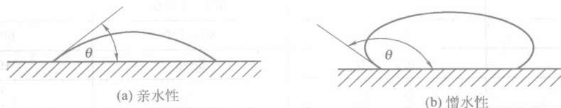
图 1-2 材料的亲水性和憎水性
