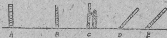
图8 两点的延长线上定线
