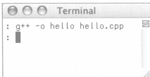
图i-3 在Mac OS X系统的终端窗口里调用g++编译器
