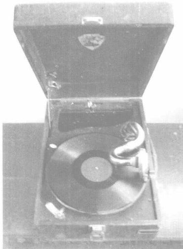
早期的留声机靠发条为动力，椅子面大小的机座上放上唱片，唱针与唱片金属膜面上的声纹接触，震动频率传到喇叭里放大发出声音。这种老式的留声机，又称唱机，我最初是在电影中见过，《英雄虎胆》中王晓棠扮演的女特务就常听这种玩
