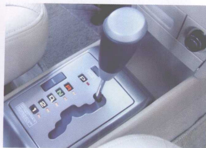
图 2-15 带背光效果的排挡面板
