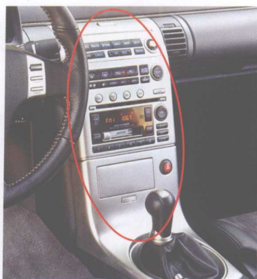
图 2-20 喷涂银色装饰漆的中控面板
