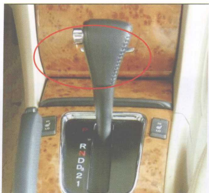
图 2-19 相邻零件之间桃木纹饰件颜色和纹理一致性
