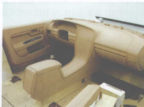
图 1-11 单一造型油泥模型
