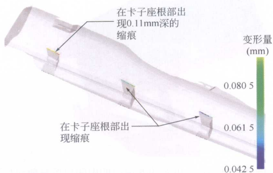
图 9-19 模流分析得到缩印的分布和深度
