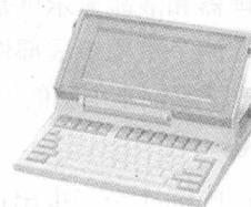
经典的笔记本电脑样式就像一本打开的书。打开之后上面的部分是显示器，下面的部分是键盘，再下面的一层是主机部分。笔记本电脑使用的是液晶显示器（LCD），而不是阴极射线管显示器（CRT）。液晶显示器画质高而且绝对不会闪烁，使用时使眼睛的疲劳程度降到最低；在防止辐射方面也具有先天的优势，因为它的辐射量小得甚至可以忽视；在电磁波的防范方面，液晶显示器也有自己独特的优势。依据不同的用途和用户需要，笔记本电脑液晶屏幕的大小尺寸也不尽相同。笔记本电脑采用小键盘或采用笔触式技术。它使用高容量的可充电电池，在无交流电的地方也能方便地使用。
