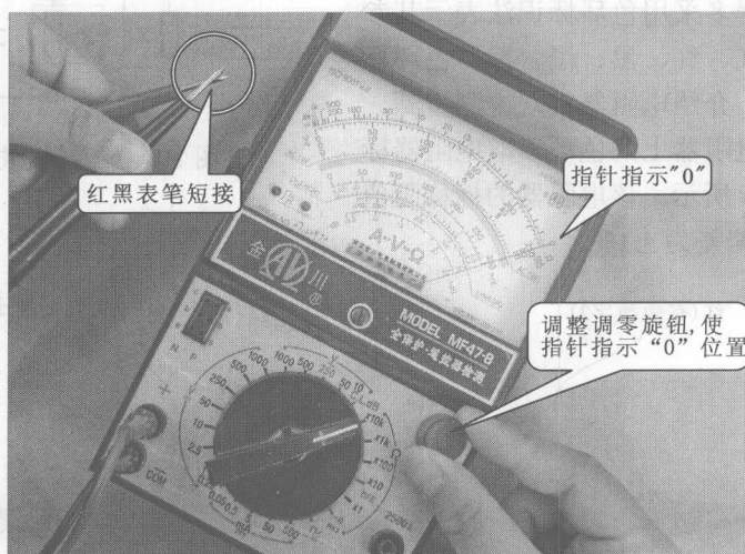
图 1-4 表针调零校正方法
