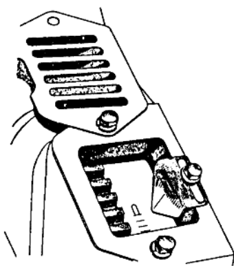
图 2-1 135 型柴油机飞轮上的 刻度线和飞轮壳上的 上止点指针
